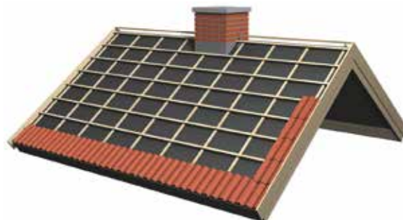
Bild 6. Lägg först en nedre rad från höger till vänster. Sedan en rad ända upp tillnocken. Se till att den ligger i vinkel mot nedersta pannraden.
