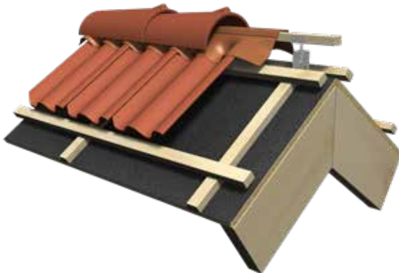
Bild 10. Det är viktigt attnock- och valmtätningssrollen inte ligger mot sidorna på nockplankan, utan endast i ovankant. Då luftas nockplankan ordentligt.
