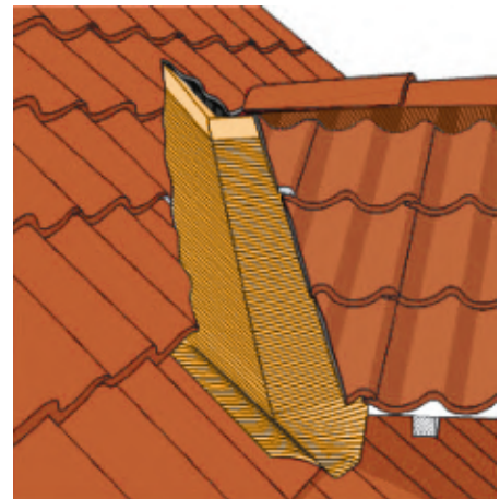
Attēls 30: Sateknes izbūve jumta mansardam
